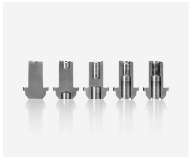
Die Kaltmassivumformung bietet insbesondere bei grossen Serien wirtschaftliche Vorteile.
